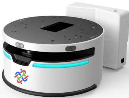
TIBI è un veicolo elettrico automatico, ideale per movimentazioni continuative tra punti stabili, di piccoli colli, ricambi, pezzi metallici o scatole contenenti minuteria. Il veicolo ha una portata massima di 45 kg ed è dotato sulla parte superiore di fori per l'eventuale aggiunta di un cesto per il contenimento dei materiali.
