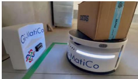
Stazione di ricarica a contatto, che in automatico dialoga con il veicolo per abilitare la ricarica, con possibilità di settaggio da parte del gestore.
