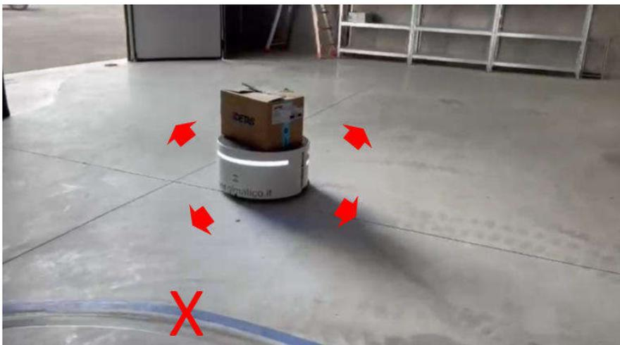
**MASSIMA FLESSIBILITA'**: grazie alla guida in natural navigation, TIBI non necessita di strisce a pavimento come i classici AGV a guida ottica. Il software a corredo permette di ricostruire in modo semplice e rapido una mappa virtuale dell'ambiente di lavoro, aggiungendo eventuali aree non accessibili e stabilendo percorsi e tempi di missione.
