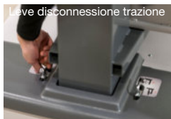
Leve disconnessione trazione
