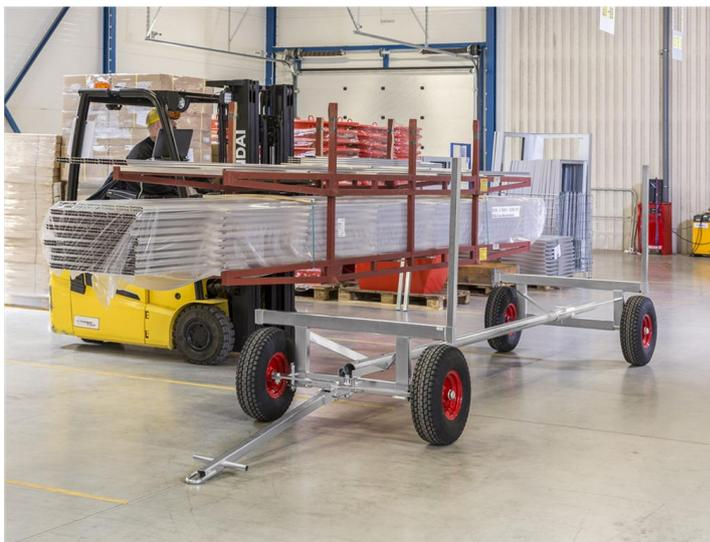
Esempio carico materiali con carrello elevatore. Aste di contenimento smontabili.
