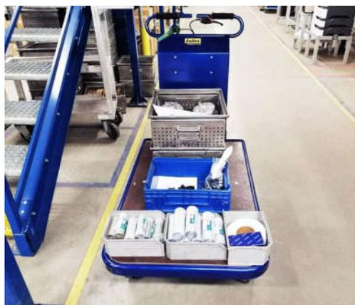
M15 è equipaggiato con batterie AGM 2x12V/45Ah esenti da manutenzione e caricabatterie esterno ad alta frequenza dotato di PFC (Power Factor Correction - correzione del fattore di potenza), che durante la ricarica migliora le prestazioni della batteria e previene picchi di corrente potenzialmente dannosi.
