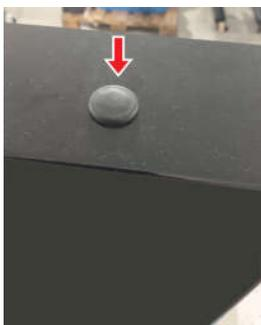
Sotto il coperchio è disponibile una vite a testa esagonale. Posizionare una chiave da 13 sulla vite a testa esagonale. Il carrello di sollevamento può essere movimentato ruotandola verso sinistra o verso destra. Premere simultaneamente il pulsante di sblocco del freno. Una volta rilasciato il pulsante, non sarà possibile muovere la forca.
