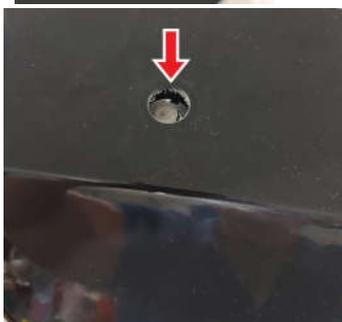
Rimuovere il tappo dalla sommità del rivestimento superiore. Sotto il coperchio è disponibile una vite a testa esagonale. Posizionare una chiave da 13 sulla vite a testa esagonale. Il carrello di sollevamento può essere movimentato ruotandola verso sinistra o verso destra. Premere simultaneamente il pulsante di sblocco del freno. Una volta rilasciato il pulsante, non sarà possibile muovere la forca.
