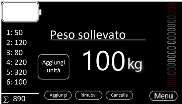
Durante il sollevamento, VANLIFT misura il carico sulle forche. Il peso corrente viene visualizzato sotto la voce "Peso sollevato". Quando le forche sono completamente abbassate, il peso misurato si azzerava. È anche possibile aggiungere il peso sulle forche e registrarlo utilizzando l'apposito pulsante. Il sistema permette di aggiungere fino a 6 pesi differenti. Il peso totale del veicolo è visibile in basso a sinistra nella schermata.
