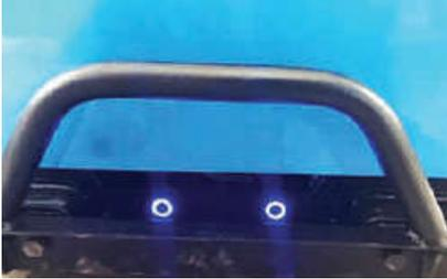
Se si utilizza il modello VANLIFT Pro Max, sotto la maniglia delle gambe di supporto è installata un'altra serie di pulsanti di sollevamento/abbassamento. Questi pulsanti funzionano parallelamente a quelli presenti sull'impugnatura e aiutano gli utenti quando l'unità viene caricata su una piattaforma elevata o su aree di carico sopraelevate.
