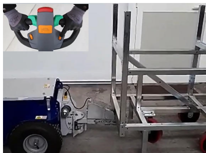
Trainatore M9 con braccio basculante e pinza elettrica, in versione 2023.
